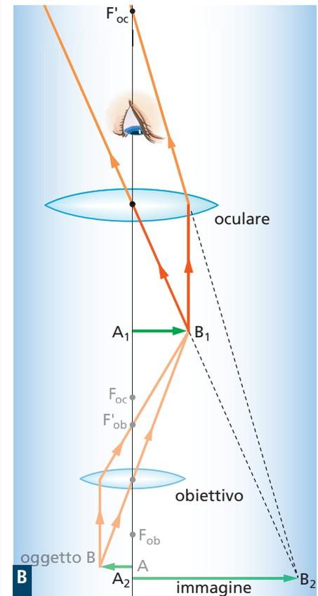
Il microscopio è progettato in modo che l'immagine  $A_2B_2$  si formi a una distanza dall'occhio pari alla distanza della visione distinta.
