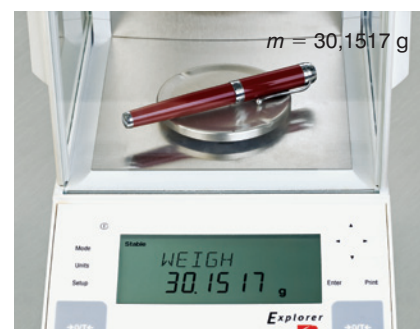
bilancia per uso analitico sensibilità 0,0001 g
