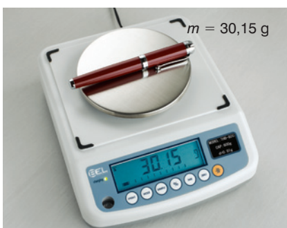
bilancia di laboratorio sensibilità 0,01 g
