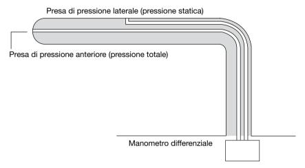
L'asse dello strumento è posizionato parallelo alla direzione della corrente fluida, in modo che sulla *presa di pressione anteriore* agisca la pressione totale, mentre sulla *presa di pressione laterale* agisce la pressione statica.
