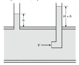
Entrambi sono in comunicazione con l'atmosfera e sono dotati di una scala graduata, con la quale è possibile misurare la colonna di fluido presente all'interno.
