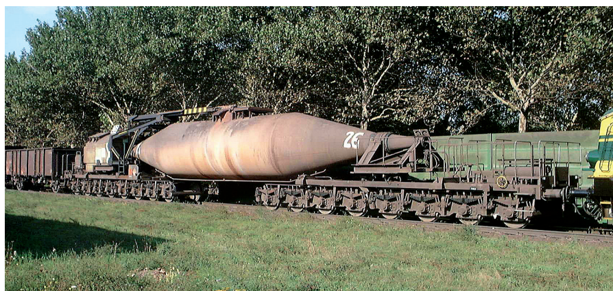
FIGURA 1 Carro silero per il trasporto della ghisa fluida dall'altoforno all'acciaiera.
