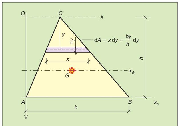
FIGURA 3 Momenti d'inerzia del triangolo rispetto ad assi paralleli alla base.
