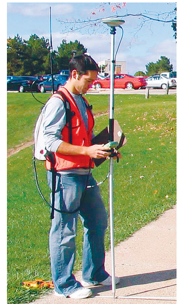
FIGURA 3 Operatore durante una sosta del rilievo stop-and-go . Si intravede l'antenna radio che esce dallo zainetto che testimonia di un rilievo in tempo reale (RTK).
