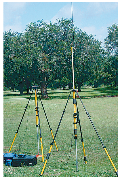
FIGURA 1 L'equipaggiamento del rilievo cinematico differenziale si compone dei seguenti elementi comuni al ricevitore base (a) e al rover (b): 1, antenna; 2, controller palmare; 3, ricevitore; 4, eventuale collegamento bluetooth per il collegamento antenna-ricevitore senza cavi. Nel caso, poi, di posizionamento in tempo reale (RTK) è necessaria l'antenna (c) per il collegamento radio (o GSM) tra i due ricevitori. Questa può essere integrata nello stesso ricevitore.
