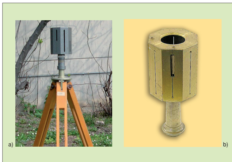
FIGURA 4 Squadro agrimensorio con treppiede e bastone di montaggio (a). Particolare delle finestrelle di traguardo (b).
