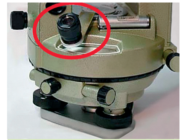
FIGURA 16 Microscopio semplice utilizzato in un goniometro ottico per ingrandire un tratto di graduazione di un cerchio.
