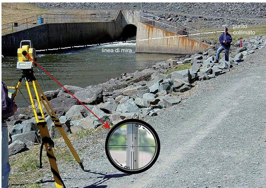
**FIGURA 1** Il cannocchiale, con la sua linea di mira, consente di collimare, in modo efficiente, punti e riferimenti di segnali e mire.
