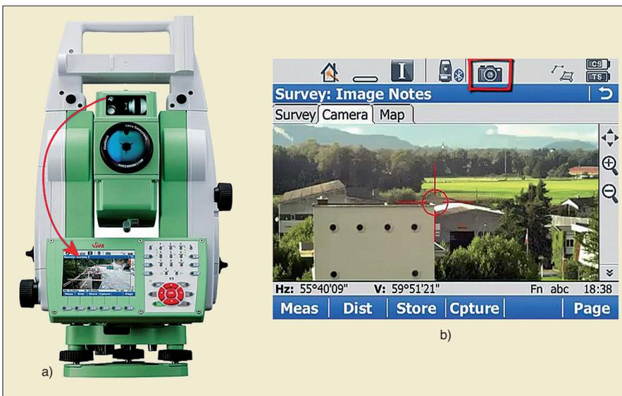
**FIGURA 18** a) Moderno strumento topografico in cui il cannocchiale è affiancato da una camera digitale, con la quale, oltre a documentare il rilievo, è possibile rendere più rapida la collimazione dei punti. b) Display touch-screen dello strumento topografico illustrato nella figura precedente; utilizzando l'apposita funzione è possibile effettuare, a certe condizioni, collimazioni a video, migliorando la produttività dello strumento.
