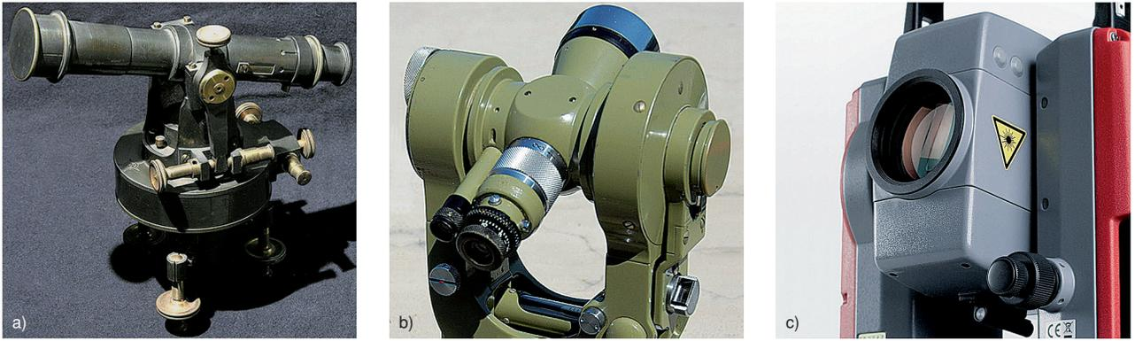
mantiene inalterate le sue caratteristiche di funzionamento. La ►FIGURA 5 illustra l'evoluzione degli aspetti esteriori che hanno subito i cannocchiali collimatori in oltre due secoli.
