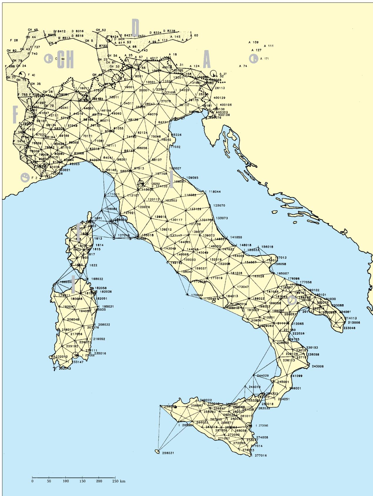
**FIGURA 9** Schema della rete fondamentale del I ordine in Italia.
