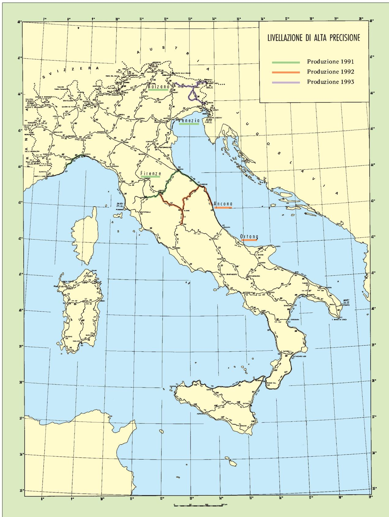
**FIGURA 23** Schema della rete di livellazione di alta precisione realizzata dall'IGM.
