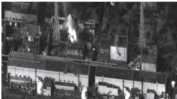
Figura 22. Una foto da satellite dei quattro reattori della centrale Fukushima Daiichi danneggiati dalle esplosioni del marzo 2011. (Per gentile concessione di Digital Globe)
