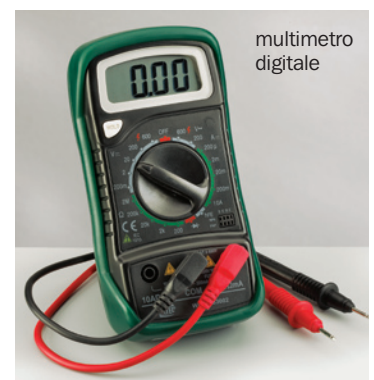
▲ Figura 27 Per convenzione, anche nei multimetri il polo positivo viene collegato con il cavetto di colore rosso, mentre quello negativo è collegato con il cavetto di colore nero.
