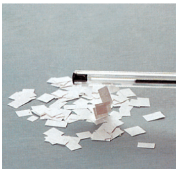
▲ Figura 1 Una bacchetta di materiale plastico, come per esempio una penna biro, se viene strofinata è in grado di attrarre pezzetti di carta; questo accade perché a seguito dello strofinio la bacchetta presenta cariche elettriche.
