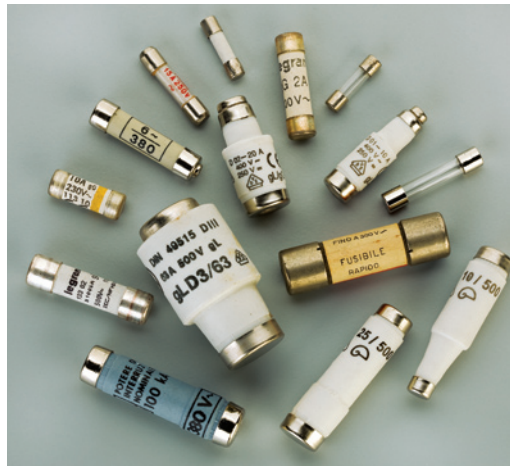
◀ Figura 29 Il fatto che i conduttori percorsi dalla corrente elettrica si riscaldano viene sfruttato nei cosiddetti fusibili di protezione , componenti elettrici costituiti da un piccolo tratto di filo metallico a basso punto di fusione. Quando la corrente supera un certo valore, per esempio a causa di un cortocircuito, il fusibile fonde, interrompe il circuito e impedisce così danni maggiori.
