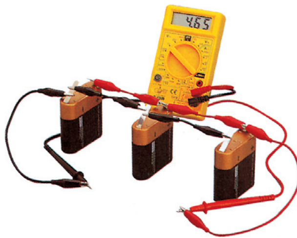
collegamento in parallelo: la fem rilevata dallo strumento corrisponde a quella di una singola pila.
