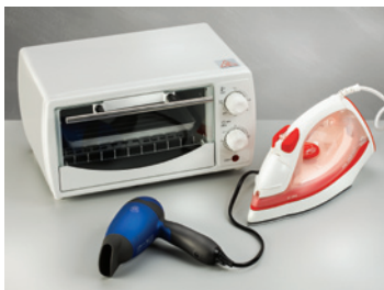
▲ Figura 28 Alcuni apparecchi elettrici che convertono energia elettrica in energia termica. Per esempio, il phon è un apparecchio elettrico che sfrutta l'effetto Joule in quanto la corrente elettrica attraversa un resistore e produce energia termica. Un motore muove una ventola che spinge l'aria riscaldata verso l'esterno. Normalmente l'interruttore può comandare l'inserimento di più resistori al fine di aumentare la temperatura dell'aria.
