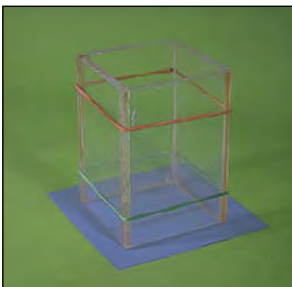
▲ Il box viene assemblato e posto su una superficie piana. Le pareti interne vengono isolate con vaselina.
