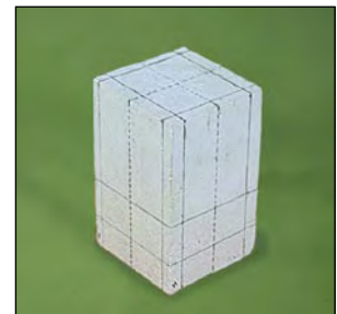
▲ Le misure del progetto di base vengono riportate sul parallelepipedo di gesso.
