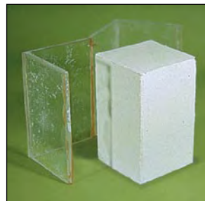
▲ Dopo l'indurimento, le pareti in plexiglas vengono separate dal blocco di gesso.
