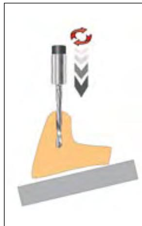
◀ Perforazione orientata sulla correzione angolare del sito, eseguita con un micromotore montato sul braccio Ray Set.
