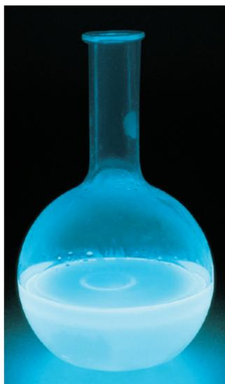
► **Figura 4** La chemiluminescenza, emissione di luce a seguito di una reazione chimica, si verifica aggiungendo perossido di idrogeno a una soluzione del composto organico perilene. Il perossido di idrogeno di per sé può risultare fluorescente, ma in questa circostanza la luce è emessa dal perilene.
