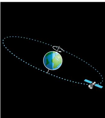
I satelliti meteorologici orbitano a 36 000 km dalla Terra e impiegano esattamente 24 ore per completare un'orbita.
