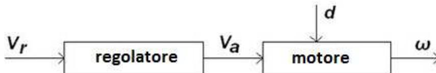
La tensione d'ingresso al regolatore  $V_r$  rappresenta il segnale di riferimento; a ciascun valore di tensione di riferimento corrisponde una ben determinata velocità del motore.
