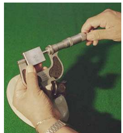
Taratura di un micrometro con blocchetti pianoparalleli.
