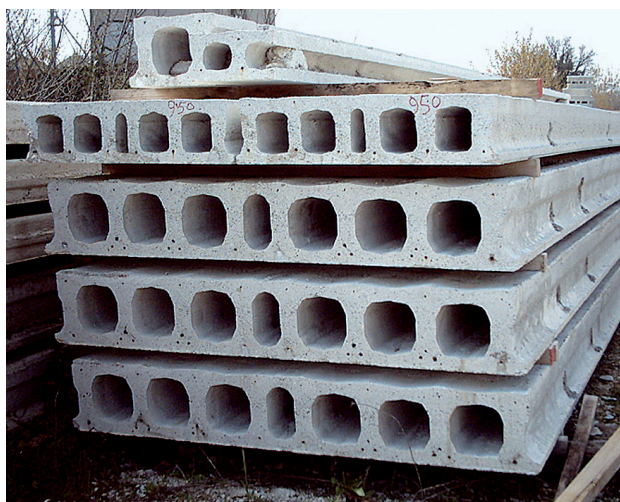
FIGURA 7 A sinistra, solaio a pannelli alveolari precompressi. A destra, tipica sezione delle travi precomprese.
