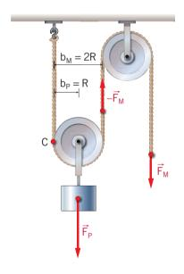
**Figura 2** Schema di funzionamento di una carrucola doppia.
