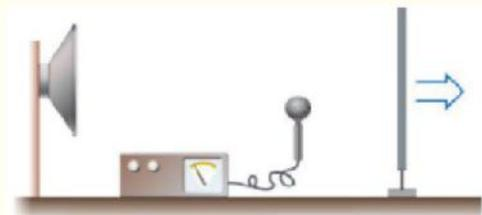
Lo schermo viene allontanato lentamente dal microfono osservando nel contempo le indicazioni di uno strumento che misura l'intensità del suono. Si nota l'esistenza di un massimo con lo schermo a 22,5 cm dal microfono; successivamente si osservano altri dieci massimi fino a che il riflettore si sposta a 36,5 cm dal microfono, dove c'è l'ultimo dei 10 massimi.
