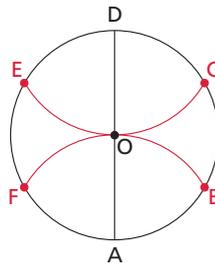
b. Mantenendo la stessa apertura OA, puntiamo il compasso in A e tracciamo l'arco  $\widehat{FB}$ ; puntiamo il compasso in D e tracciamo l'arco  $\widehat{EC}$ .
