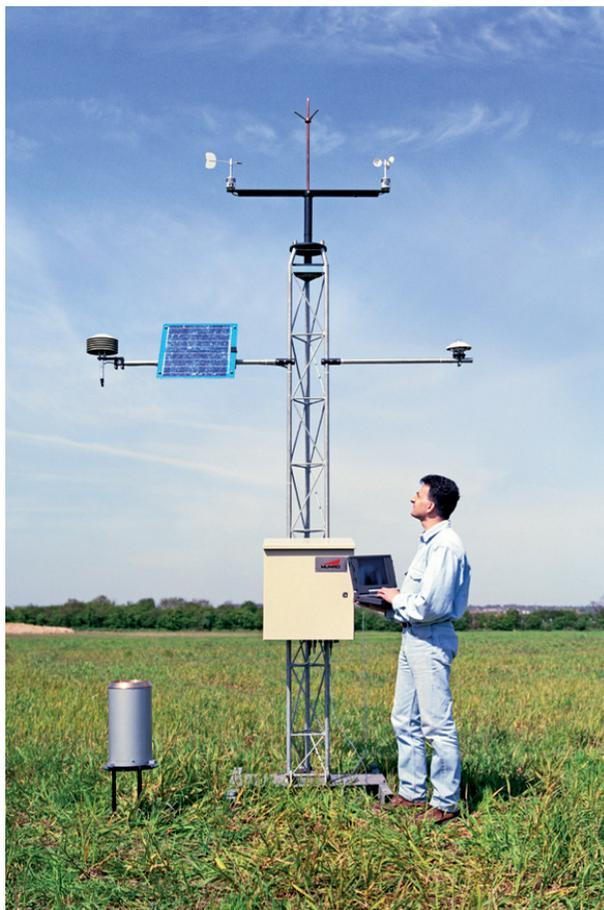
**FIGURA 4** Un meteorologo controlla una stazione di rilevamento meteorologico, alimentata a energia solare. Le stazioni meteorologiche sono dotate di centraline elettroniche che raccolgono i dati di numerosi strumenti, tra cui piranometri per la rilevazione dell'irradiamento solare, igrometri per la misura dell'umidità dell'aria, termometri, anemometri e banderuole per la misura della velocità e della direzione del vento.
