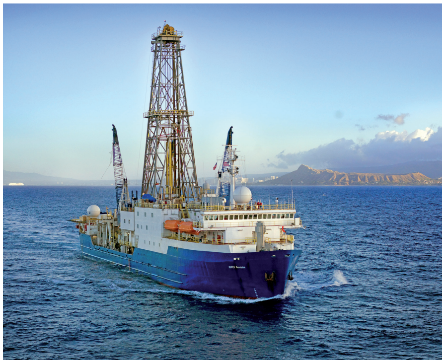
La Joides Resolution ( Joint Oceanographic Institutions Deep Earth Sampler ), inizialmente varata come petroliera e successivamente trasformata in nave oceanografica, dal 1984 sta solcando mari e oceani, perforando tutti i fondi oceanici del globo. Lunga quasi 150 m e larga 21, ha un equipaggio di 65 marinai e uno staff tecnico e scientifico di 50 persone ed è in grado di effettuare trivellazioni fino a profondità di 9 000 m. I suoi laboratori svolgono numerose funzioni, dallo stoccaggio frigorifero alla fotografia, dall'elettronica all'analisi chimica, dall'analisi ai raggi X all'analisi microscopica. Il laboratorio di geofisica raccoglie ed elabora dati magnetici e registra informazioni riguardanti la batimetria e la topografia del fondo oceanico. (foto: William Crawford & IODP)
