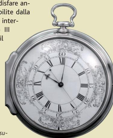
Figura 2. John Harrison risolse il problema della longitudine col suo cronometro, noto come H4, che misurava solo una dozzina di cm di diametro.
