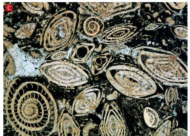
Rocce in sezione sottile viste al microscopio. (A), una roccia magmatica (andesite) vista a luce naturale; (B), la stessa roccia a luce polarizzata mostra i colori brillanti dei minerali che la compongono (×23). (C), una roccia sedimentaria composta da minuscoli frammenti di gusci di microrganismi marini (nummuliti) (×15).
