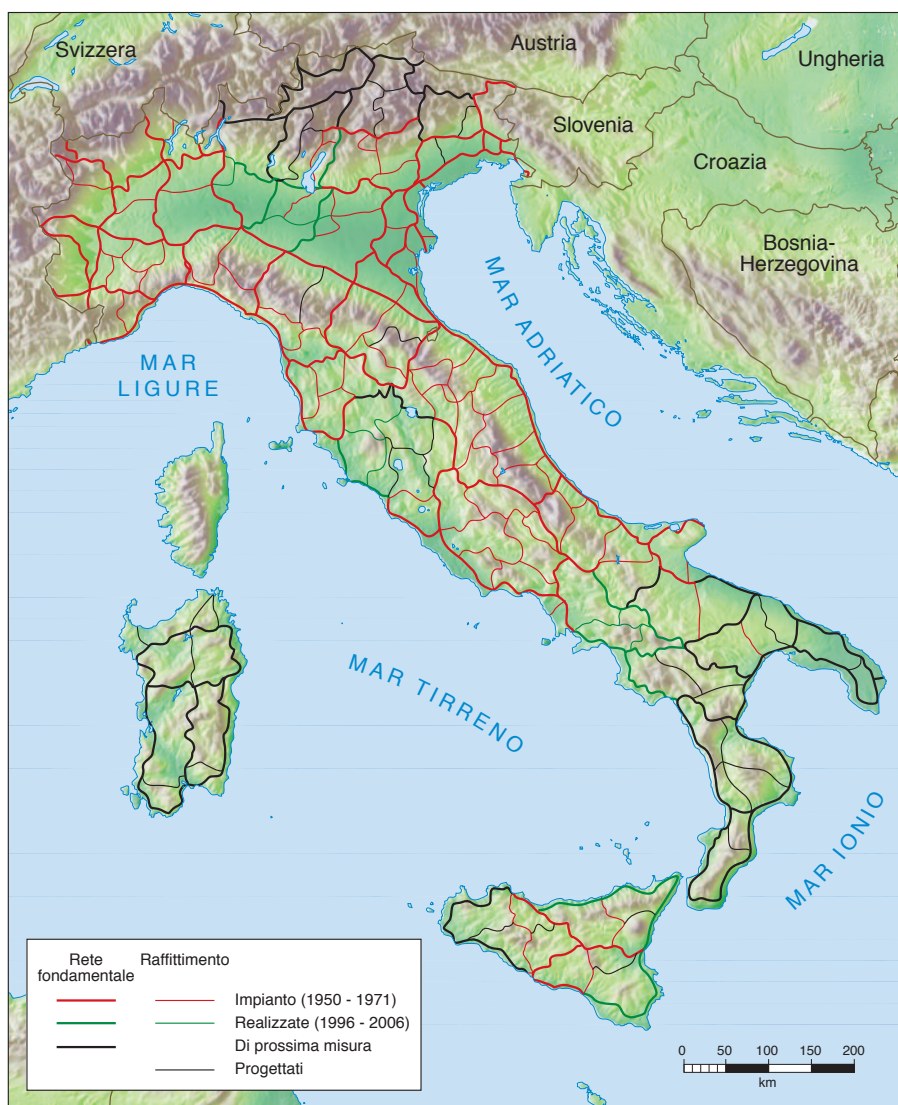
FIGURA IV.4 Rete di livellazione di alta precisione. Questa rete di livellazione è stata realizzata fra il 1950 e il 1971. Inizialmente essa era formata da circa 13.000 capisaldi collocati lungo la rete viaria nazionale. Attualmente è in corso un raffittimento che porterà ad ottenere oltre 20.000 capisaldi.
