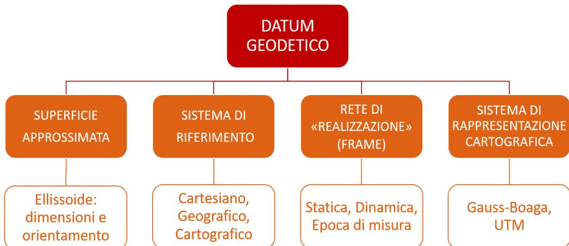
**Figura 1** – Componenti di un *datum* geodetico.
