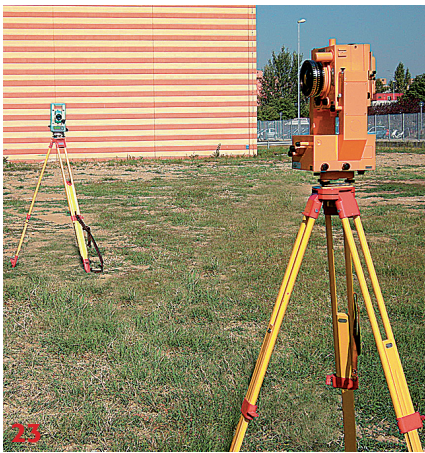
FIGURA 23 Operazioni di presa con camera metrica Zeiss UMK-10 (sul primo punto della base di presa) e teodolite elettronico per rilevare i punti di appoggio (collocato sul secondo punto della base).
