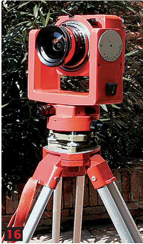
FIGURA 16 Camera metrica Wild P31 montata su basamento della stessa ditta. Ciò permette l'intercambiabilità della camera con goniometro e mire.
