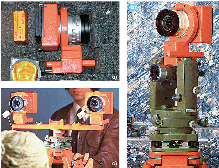
FIGURA 12 Camera metrica Wild P32: nella sua custodia (a), accoppiata al tacheometro T16 della stessa casa (b) e utilizzata in coppia con una camera identica su barra calibrata (bicamera) (c).
