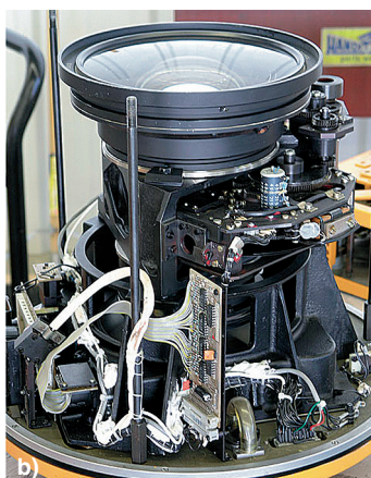
FIGURA 8 Camera Zeiss Jena LMK (a) e blocco interno di una camera che mette in evidenza la lente terminale dell'obiettivo e, in primo piano, l'automatismo di apertura dell'otturatore (b).
