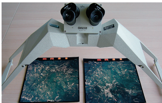
FIGURA 24 Stereoscopio a specchi da tavolo. In questo caso i fotogrammi da osservare sono stampati in scala reale su carta fotografica opaca.
