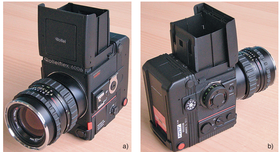
FIGURA 13 Camera semimetrica Rolleiflex 6006: vista frontale (a) e vista di retro (b).
