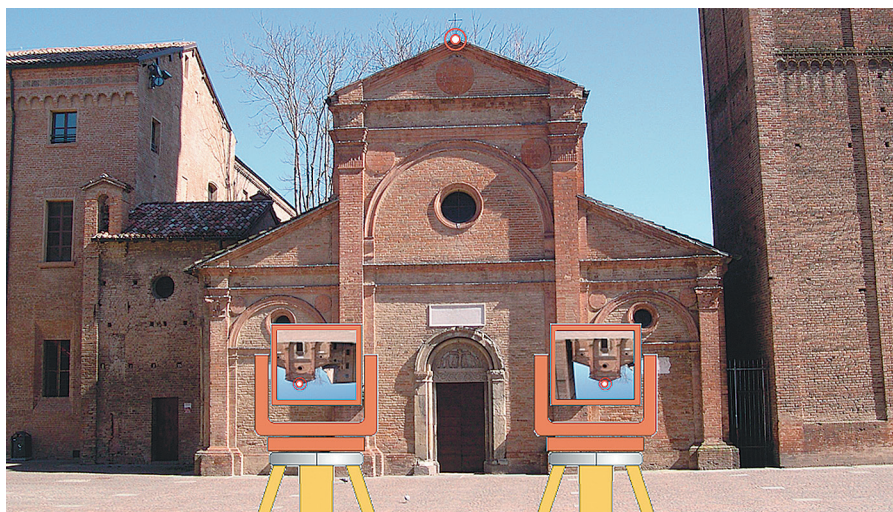
FIGURA 1 La fotogrammetria consente il rilievo di oggetti tridimensionali senza avere alcun contatto fisico con essi, ma utilizzando immagini fotografiche effettuate da diversi punti di presa. In esse un punto dell'oggetto deve essere ripreso in entrambe le immagini e in differenti posizioni.
