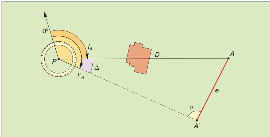
**FIGURA 1** Centramento del punto collimato  $A$ , non visibile dalla stazione  $P$ .
