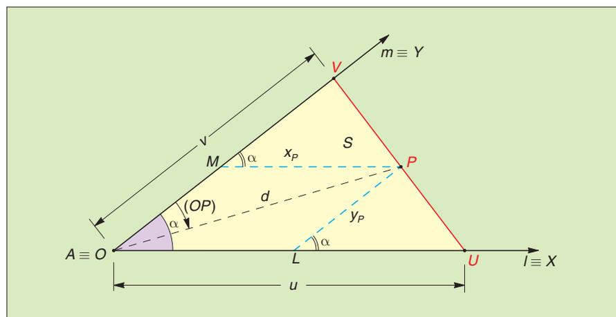
**FIGURA 1** Problema generale della dividente rettilinea passante per un punto interno all'appezzamento. La posizione del punto  $P$  viene rilevata tramite le coordinate cartesiane  $x_p$  e  $y_p$ .
