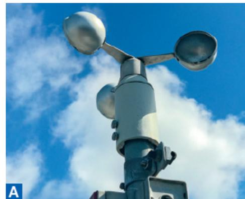
Gli anemometri misurano la velocità del vento.
