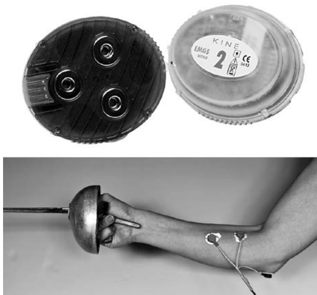
Figura 5. Sopra: elettrodi per l'elettromiografia senza fili. Sotto: elettrodi classici applicati al braccio di uno schermatore; l'amplificatore e il filtro sono all'interno della cartuccia visibile in basso.
