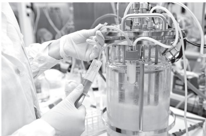
Figura 42. Nei bioreattori i microorganismi crescono in condizioni controllate per produrre sostanze chimiche di interesse farmaceutico o industriale. Foto: borzywoj/Shutterstock
