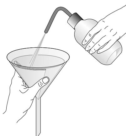
Accostate il beccuccio del becher alla bacchetta e travasate il liquido nel filtro senza riempirlo completamente.
