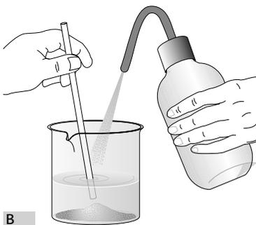
Travasate la soluzione, poi lavate il becher con piccole quantità di acqua distillata versando il liquido nel matraccio.
