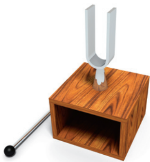
▲ Figura 13 Il diapason è uno strumento costituito da una forcella in acciaio a forma di U i cui rami sono detti rebbi. Quando è percosso, il diapason genera un suono puro (detto armonica) di una ben determinata frequenza. Per accordare gli strumenti musicali si usa un diapason che emette la nota «la», il suono costituito da onde con la frequenza di 440 Hz.
