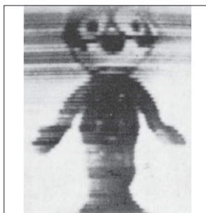
Così appariva l'immagine sul televisore con disco di Nipkow (il soggetto che vediamo è Felix, un personaggio dei fumetti). Le poche linee di scansione fornivano immagini scadenti.
