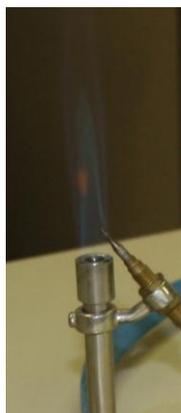
La struttura del bunsen consente, attraverso una ghiera ruotabile, di variare il flusso dell'aria, e quindi dell'ossigeno, durante la combustione, per cui si possono avere due tipi di fiamme:
