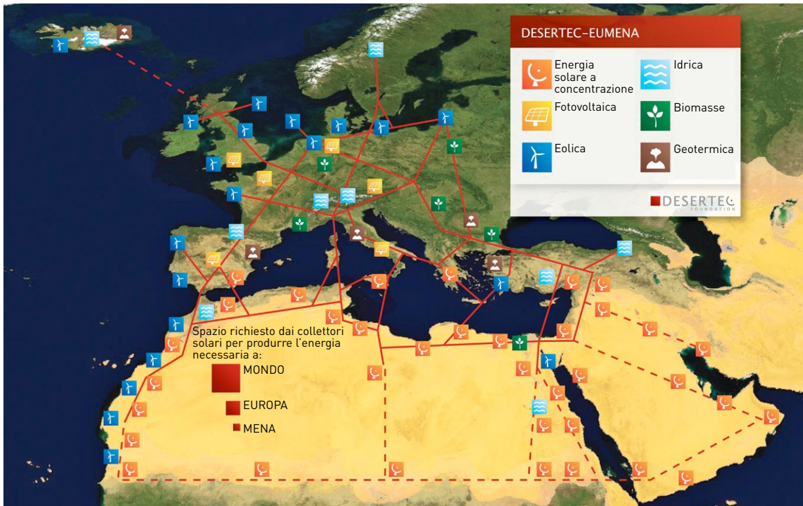
Fig. 1 La visione del progetto DESERTEC è trasformare il sole del deserto in elettricità. Questo è uno schema di possibili infrastrutture per la creazione di energia per l'Europa, il Medio Oriente e il Nord Africa (EU-MENA). I quadrati in rosso indicano lo spazio richiesto dai collettori solari per produrre l'energia richiesta, rispettivamente, dal mercato mondiale (Mondo), dall'Europa, dai Paesi del Medio Oriente e del Nord Africa (MENA). Dati del Centro tedesco di Ricerca Aerospaziale (DLR, 2005).
