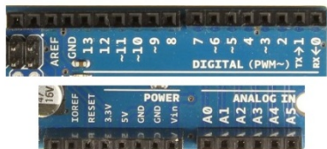
Figura 3 Visione dettagliata della piedinatura della scheda
