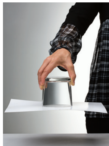
▲ Figura 5 Nonostante questa semplice prova susciti ancora molta sorpresa, sta di fatto che la forza esercitata dalla pressione atmosferica impedisce all'acqua di cadere dal bicchiere. Per verificarlo, è sufficiente riempire completamente un bicchiere, appoggiarvi un foglio di carta lucida facendolo aderire e poi, con cautela, rovesciarlo!
