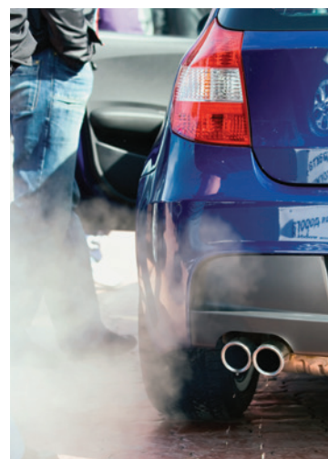
▲ Figura 3 Il particolato è il principale componente degli sbruffi di fumo che si vedono uscire spesso dal tubo di scappamento dei veicoli. Questo accade soprattutto nella combustione del gasolio nei motori diesel.
