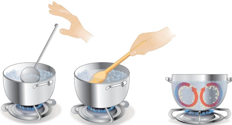
Il mestolo d'acciaio lasciato nell'acqua bollente... scotta! Il cucchiaino di legno lasciato per uno stesso tempo si scalda solo moderatamente. L'acciaio conduce il calore meglio del legno, che è un buon isolante termico.
