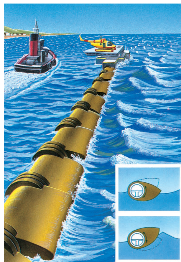
Figura 1 Schema di funzionamento delle «anatre di Salter».
