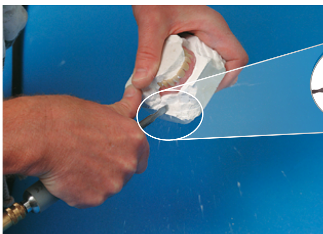
Un piccolo martello pneumatico ad aria compressa, detto trimmer , che serve per la rimozione del gesso dalle muffole e dalle basi degli articolatori, o del rivestimento dai cilindri dopo la fusione. Va usato con cautela per non rovinare i dispositivi. Vista in sezione dell'interno del trimmer (A).
