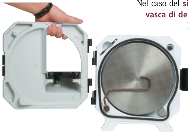
Particolare del sistema ad acqua di una squadramodelli.
