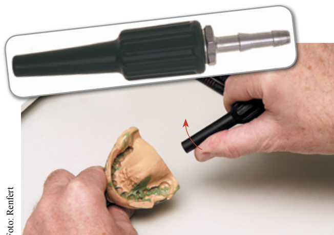
Pistola ad aria compressa da banco, utilizzata per pulire le lavorazioni dalle polveri, dalla limatura ecc. Per far uscire l'aria, si deve piegare lateralmente il terminale in gomma.
