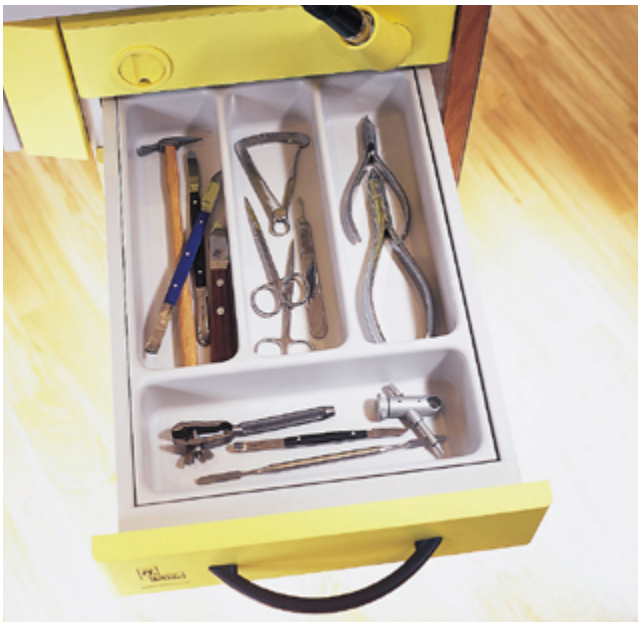
Cassetto del banco con vari scomparti per lo strumentario (martellino, coltello da cera, coltello da gesso, spessimetro, forbici, pinze varie, spatole da impasto ecc.).
