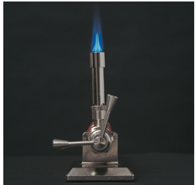
Becco bunsen per il riscaldamento degli spatolini.
