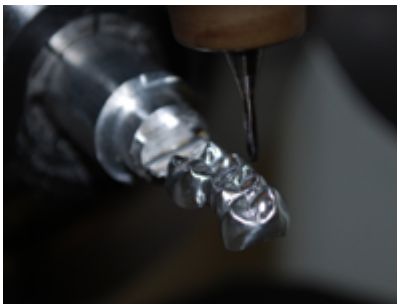
Dispositivo protesico fresato in titanio , ovvero realizzato con un processo per sottrazione .
