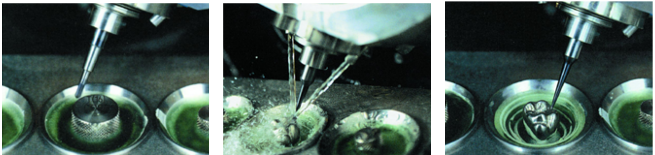
Fresatura di una corona singola in titanio. Si può notare come tutto il processo avvenga per sottrazione di materiale dal blocchetto iniziale.
