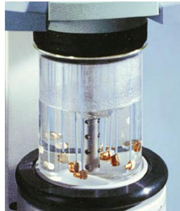
Nella tecnica AGC l'**elettrolita** è costituito da un bagno d'oro, l'**anodo** è un cestello (o un tubo) in titanio platinato, e il **catodo** sono i monconi da galvanizzare.
